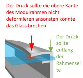
Abbildung 1a: Druck auf die Klemmenstellen
