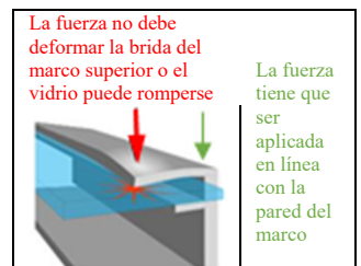
Figura 1a: Ubicaciones de la fuerza de la abrazadera
